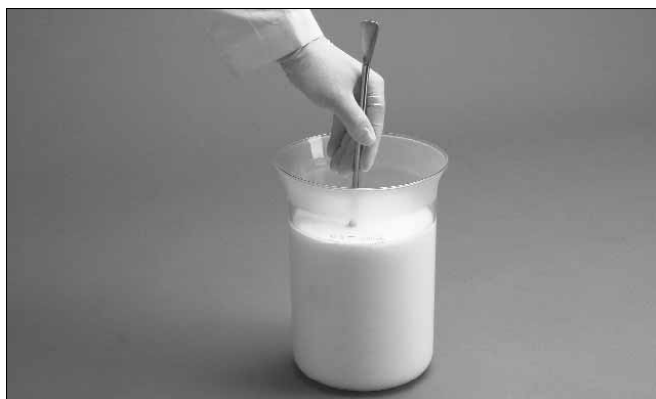
图 6. 填料浆液的再悬浮
